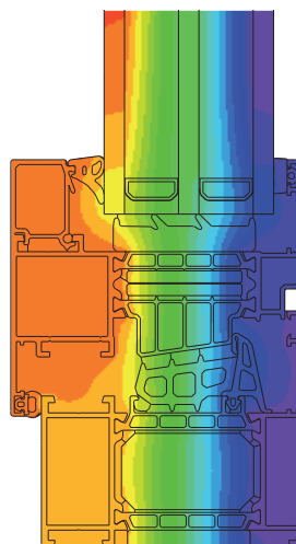
Isothermverdeling in een raam van het type MB-86N SI
